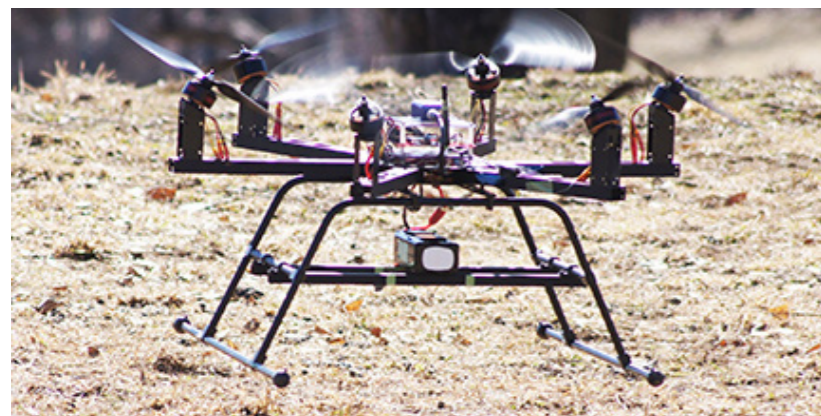
図1：並進運動と回転運動の独立制御を実現した、非平面型ドローン。
